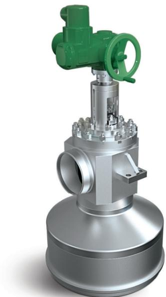
Клапан регулирующий БРУ-Д предназначен для редуцирования потока пара в деаэрактор турбоустановки АЭС. БРУ-Д поддерживает давление в деаэраторе при работе турбины в различных режимах.
