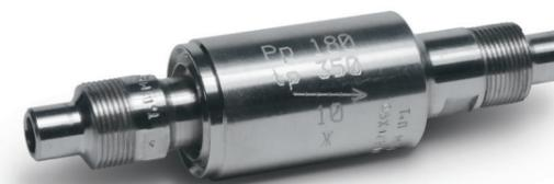
Предназначены для автоматического отключения импульсных трубопроводах или дренажно-продувочных линий АС систем нормальной эксплуатации и систем безопасности атомных электростанций в случае появления течи за отключающим устройством. При выравнивании давления за и до отключающего устройства оно автоматически переходит из закрытого состояния в открытое.
