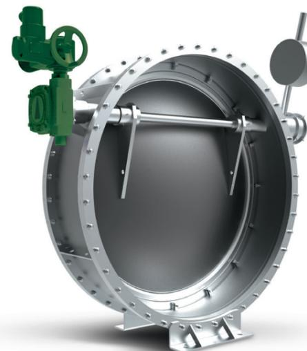
Клапаны запорно-обратные (КЗО) с электроприводом (с функциями запорного клапана и обратного клапана) предназначены для эксплуатации в вентиляционных системах, расположенных в герметичной оболочке АЭС. Выполняют функции запорного клапана во время пуска и выхода на режим вентиляторной установки.
